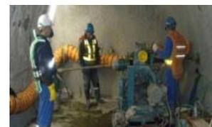
掘削に伴う応力変化の測定
