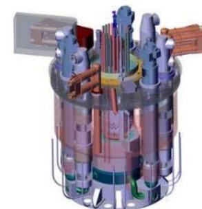
ナトリウム冷却高速炉
